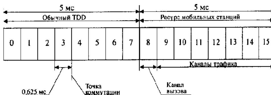
Рис. 8.8. Структура кадра в совмещенном режиме ODMA/TDD
