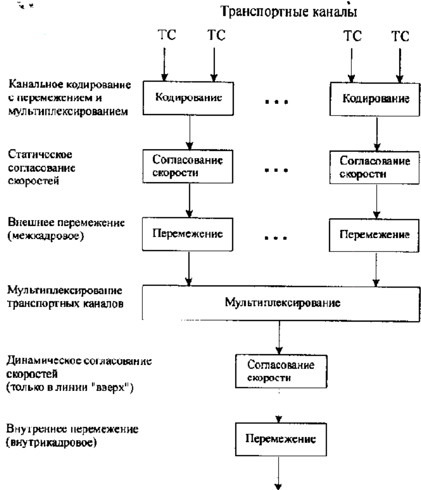
Рис. 7.15. Схема кодирования транспортных каналов
